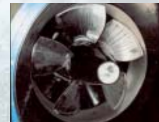
5-flügliges Laufrad der Kaplan turbine von unten
